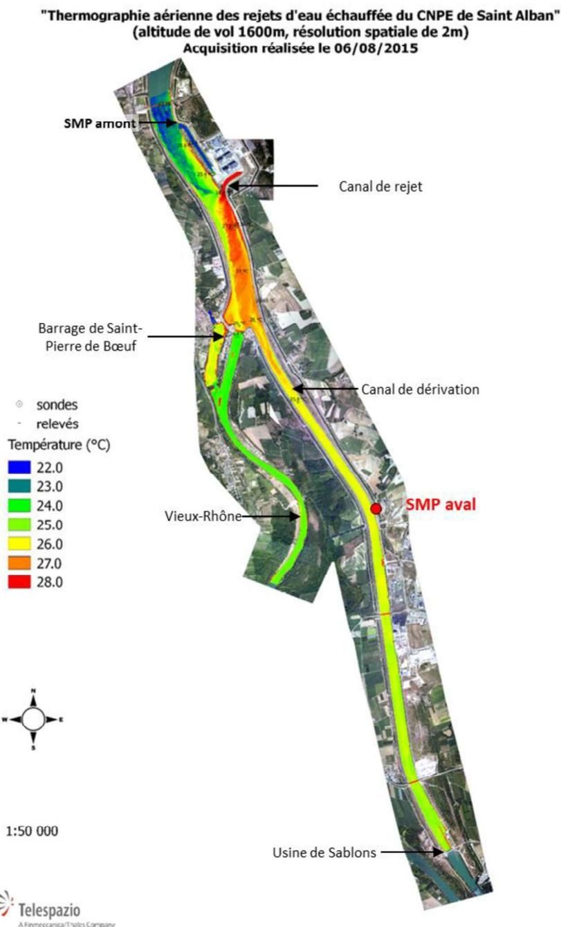
**Figure 12 : Thermographie aérienne du panache thermique du CNPE de Saint-Alban le 6 août 2015 (débit du Rhône d'environ 624 m<sup>3</sup>/s et température amont de 22,4 °C). Le CNPE fonctionne à pleine puissance durant la campagne avec un échauffement calculé après mélange de 1,8 °C.**
