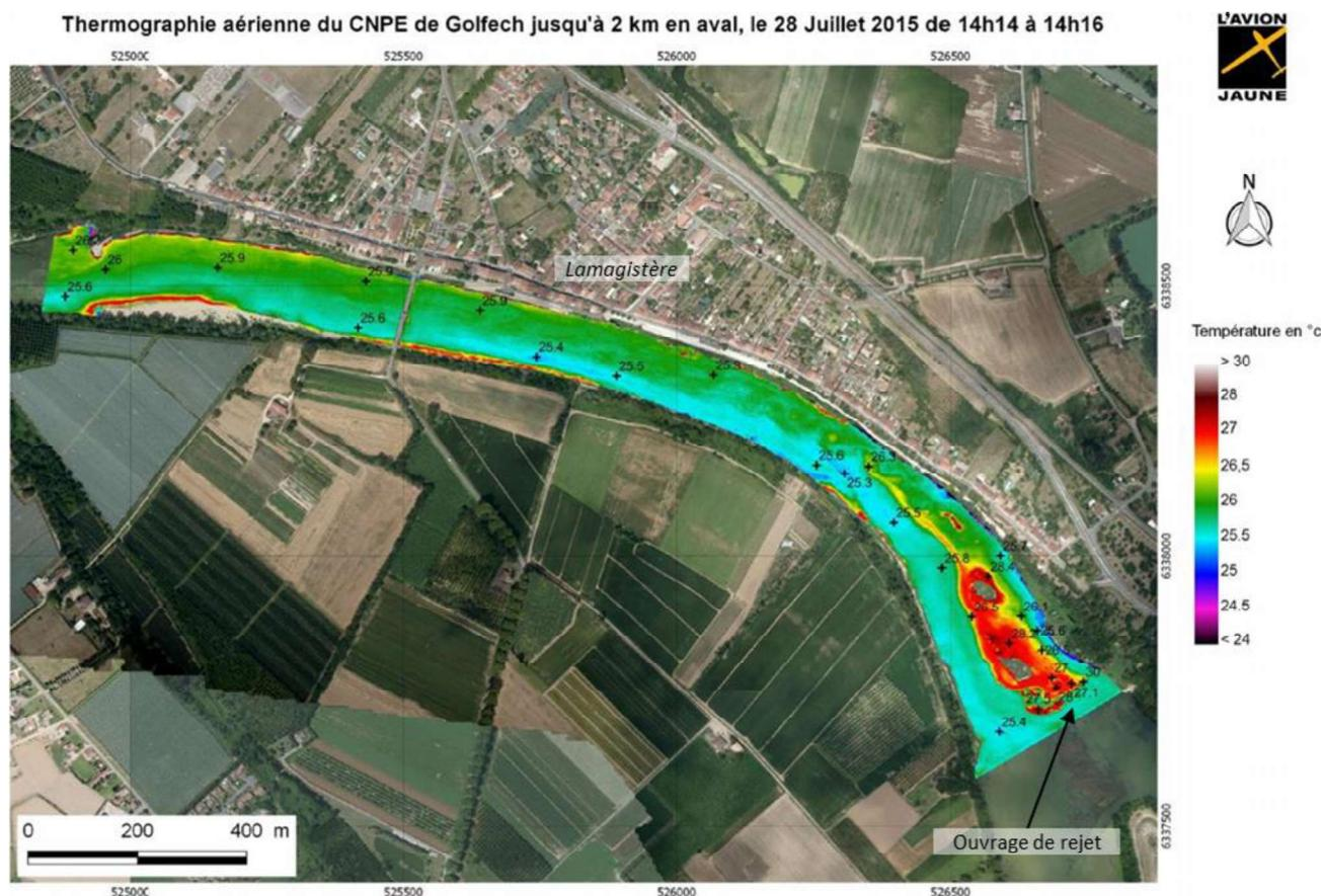
**Figure 2 : Thermographie aérienne du panache thermique du CNPE de Golfech durant l'été 2015 (vue sur 2 km).**
