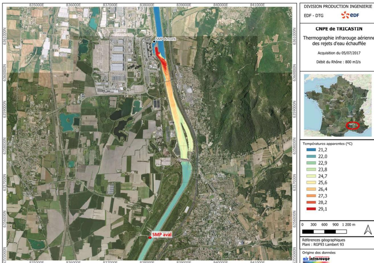
**Figure 19 : Thermographie réalisée le 5 juillet 2017 en aval du CNPE du Tricastin. Le débit du Rhône est d'environ 790 m<sup>3</sup>/s, le CNPE fonctionne à 75% de sa puissance nominale.**
