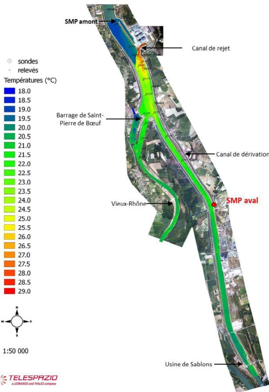
**Figure 14 : Panache thermique acquis par infra-rouge le 06/07/2016 pour un débit moyen du Rhône de 860 m<sup>3</sup>/s et une température amont de 19,6°C. Le CNPE fonctionne à 95 % de puissance.**
