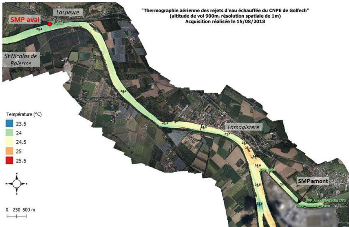
**Figure 4 : Thermographie aérienne du panache thermique du CNPE de Golfech durant l'été 2018.**
