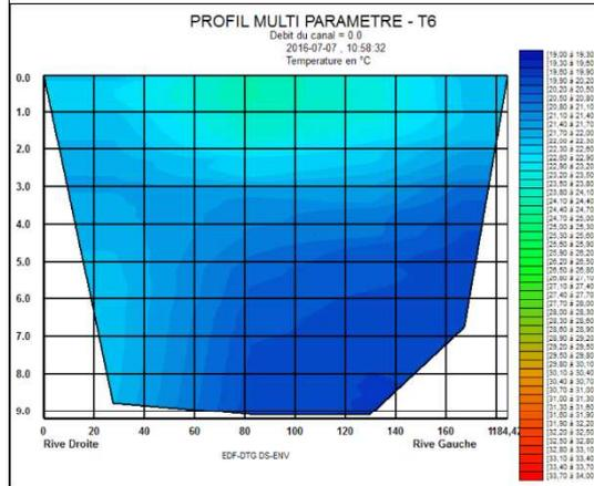
**Figure 15: Transects de température en aval du CNPE de Saint-Alban réalisés le 07/07/2016. Le débit du Rhône est d'environ 900 m<sup>3</sup>/s, le CNPE fonctionne à 95 % de sa puissance nominale.**
