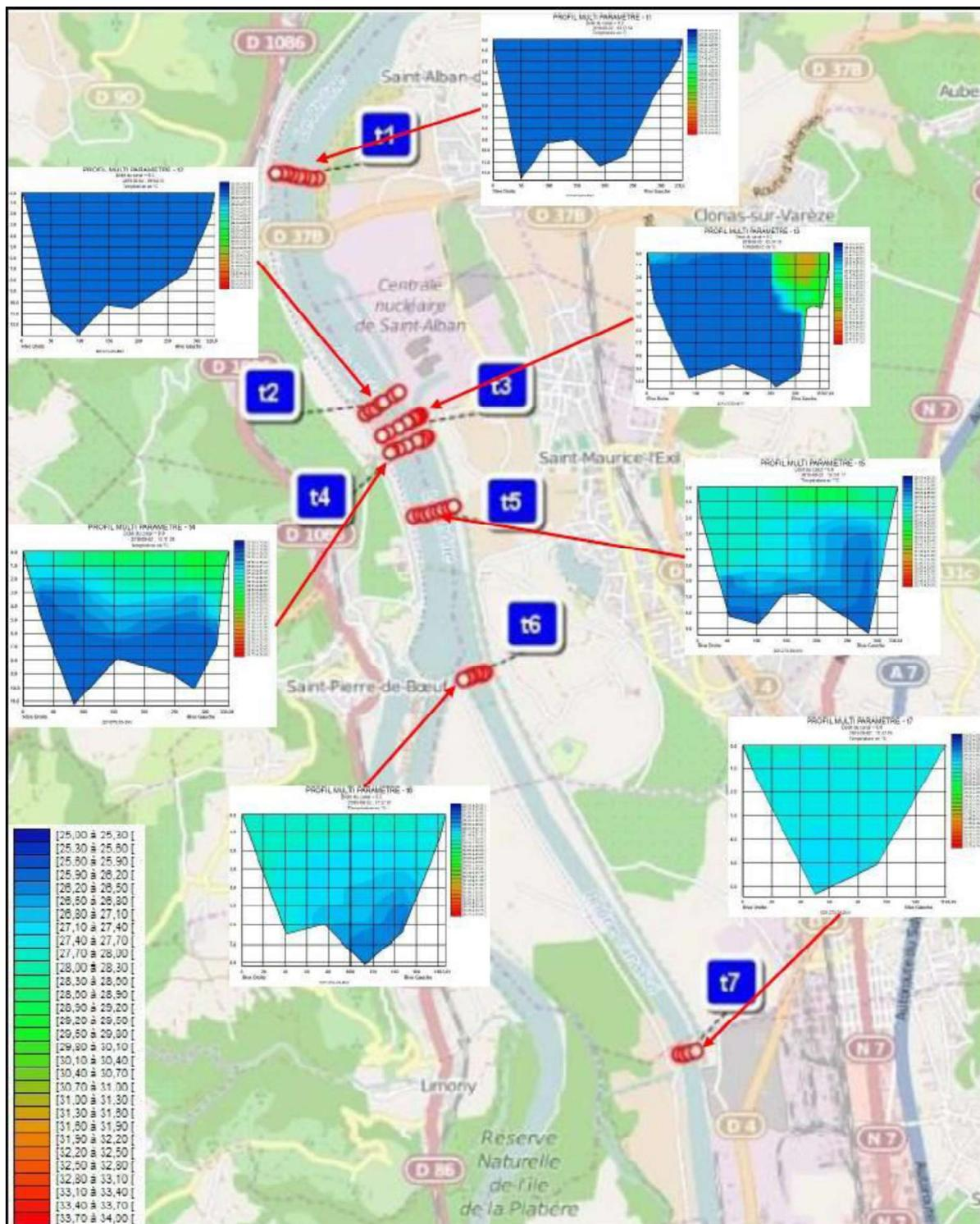
**Figure 16 : Profils de température réalisés en aval de Saint-Alban le 02/08/2018. Le débit du Rhône est d'environ 530 m<sup>3</sup>/s, le CNPE fonctionne à 50% de sa puissance nominale.**
