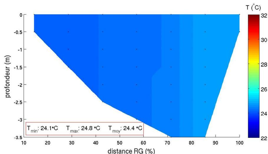
**Figure 8 : Profils thermiques en aval du CNPE de Bugey le 22 août 2009**
