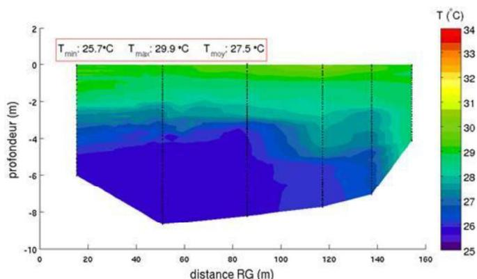
**Figure 13 : Transects de température en aval du CNPE de Saint-Alban le 7 juillet 2015 (débit du Rhône de 600 m<sup>3</sup>/s et température du Rhône de 25,5 °C en amont). Le CNPE fonctionne à pleine puissance et l'échauffement calculé après mélange est de 1,9 °C.**
