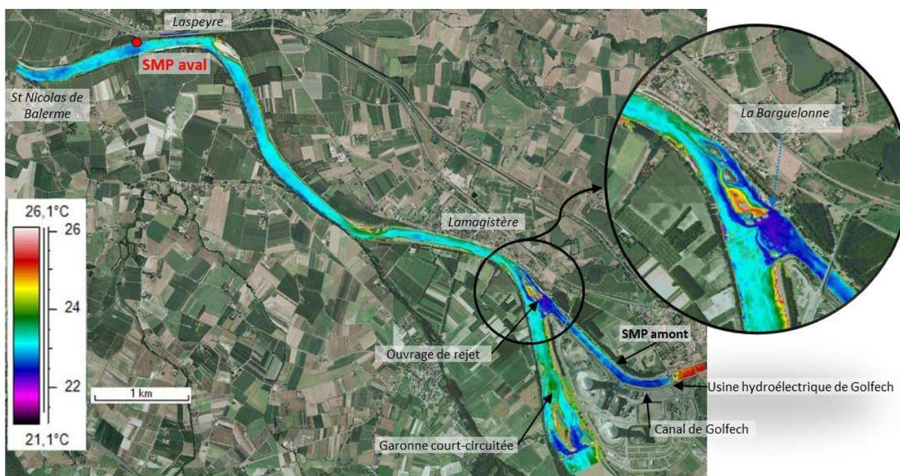
**Figure 1 : Thermographie aérienne du panache thermique du CNPE de Golfech durant l'été 2006.
