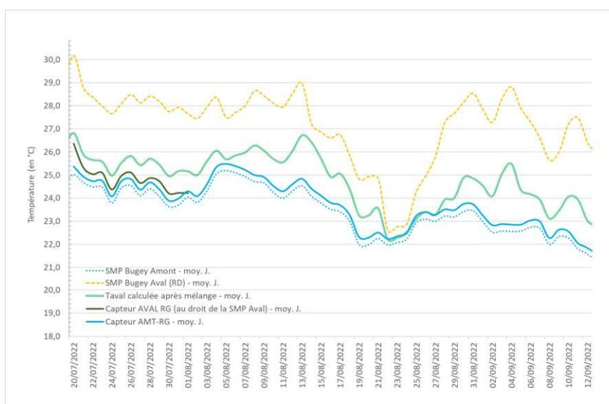
**Figure 11 : Températures mesurées en rive droite et rive gauche du Rhône à Loyettes (capteur aval RG et SMP aval située en rive droite) comparées à la température aval calculée après mélange et à la température mesurée à la SMP amont (en moyennes journalières) en 2022**
